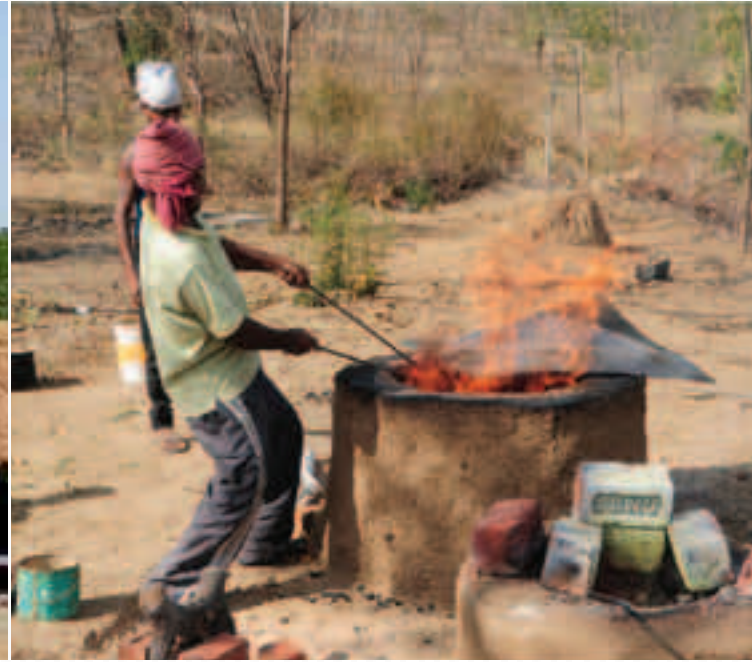
ढोकरा कलाकारों द्वारा संग्रहालय की मुक्ताकाश प्रदर्शनी पारम्परिक तकनीक में धातु प्रगलन तकनीक का प्रदर्शन व संबंधित प्रादर्श की स्थापना। Demonstration of metal casting technique and installation of related exhibit by Dhokara artists in Museums open air exhibition Traditional Technology.
